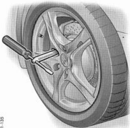
Vissage de l'auxiliaire de montage sur les véhicules sans PCCB
