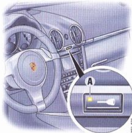
A - Diode lumineuse du système d'alarme
