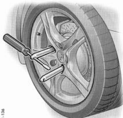
Vissage de 2 auxiliaires de montage sur les véhicules avec PCCB
